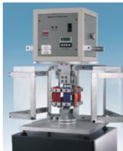
Urządzenie do badania odporności próbki na wielokrotne zginanie – De Mattia.
