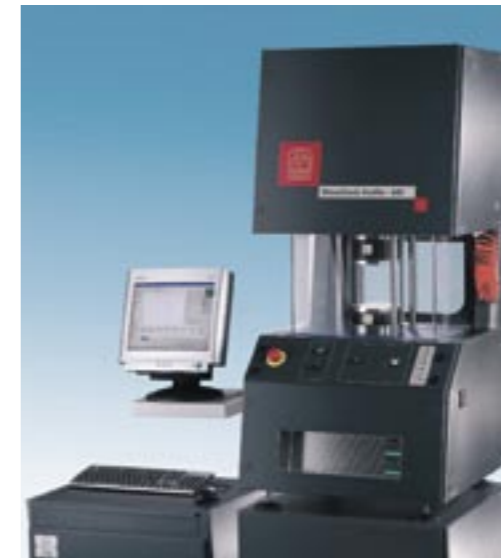
Reometr z ruchomą głowicą badawczą (MD) kontrolowany przez komputer osobisty.
