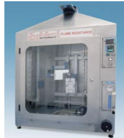
Najnowszy sprzęt Gibitre Instruments – komora do badań palności.
