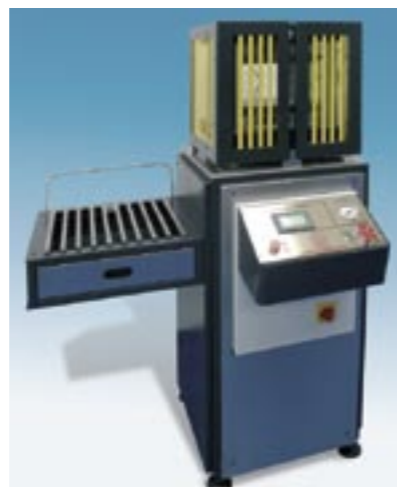
Prasa laboratoryjna służąca do przygotowywania próbek do badań laboratoryjnych.
