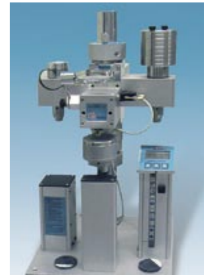
Czerogłowicowy twardościomierz mierzący wymiennie 4 różne twardości według wybranych skali twardości.
