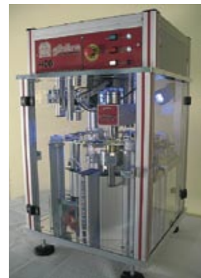
Urządzenie do automatycznego pomiaru twardości oraz gęstości mierzące do 20 próbek jednocześnie.
